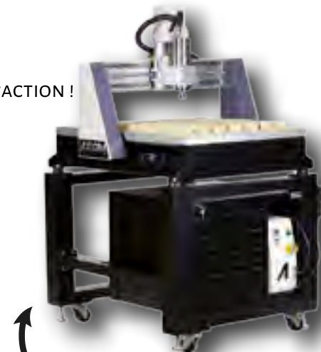
AXIOM AR8-PRO+ UTILISÉE POUR TAILLER LA MOUSSE
